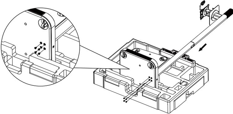
4. Halten Sie den Ständer hoch, montieren Sie dann Display und Ständer. Sie können das Display leichter halten, indem Sie den „Hohlraum“ des Displays und die „Halterungshaken“ des Ständers nutzen. Platzieren Sie den Stromanschluss auf der linken Seite. Anschließend können Sie das Display am Ständerhalter einsetzen, bis Sie ein Klickgeräusch hören.
