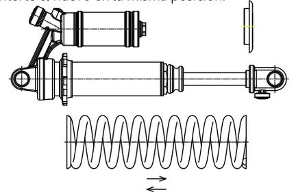
6. Volver a instalar el fiador como lo que muestra en el dibujo. Deje que la parte plana del muelle siga quedando afuera.
