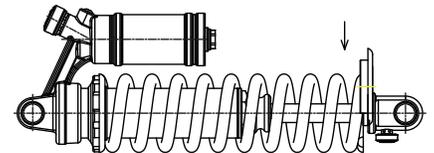
7. Otra vez aplique con un gran fuerza contra el lado del amortiguador, Otra vez aplique con un gran fuerza contra el lado del amortiguador, en cuando se comprima el muelle, el fiador deslizará a su posición original.
