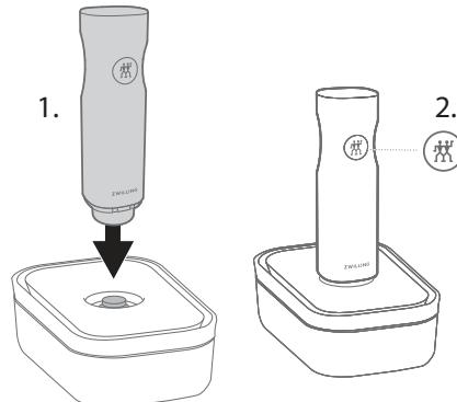
La pompe à vide s'arrête automatiquement lorsque la pression de vide atteint le bon niveau. Il est également possible d'arrêter l'emballage sous vide manuellement à tout moment en appuyant sur le bouton MARCHE/ARRÊT.
