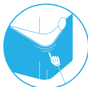
Optionaler Gewebefilter: Ein Gewebefilter fängt größere Partikel auf und erhöht die Nutzungsdauer des Hauptfilters.
