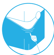
Opcjonalny filtr wstępny z tkaniny: Filtr wstępny z tkaniny wychwytuje większe cząsteczki i wydłuża okres eksploatacji filtru głównego.
