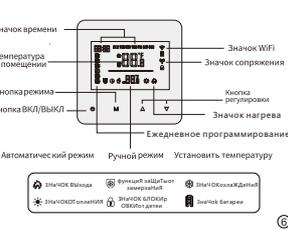
**■ Настройки дополнительных параметров устройства**
