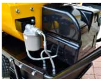
Le chauffage reçoit le carburant provenant du réservoir en dessous, mais peut également être raccordé à un réservoir externe. Le filtre à carburant est externe. Le réchauffeur de carburant est interne, dans la tête de combustion.
