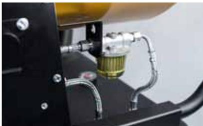
Le réchauffeur de carburant est proposé en option, le filtre à carburant est installé à l'extérieur
