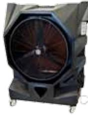
Les rafraîchisseurs évaporatifs Master refroidissent l'air à l'aide d'un processus naturel simple : l'eau d'évaporation diminue la température de l'air. Une pompe prélève l'eau d'un réservoir et humidifie un large filtre en cellulose naturelle. Un ventilateur puissant aspire l'air à travers le filtre. L'eau s'évapore du filtre et diminue la température de l'air de plusieurs degrés. L'air frais et propre circule dans l'air ambiant et le refroidit.
