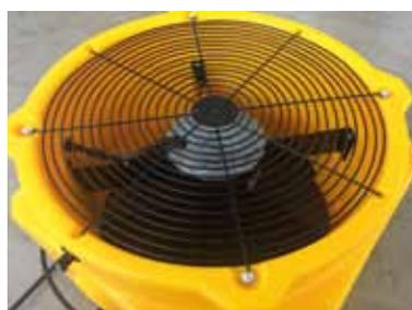
**Ventilateur axial DFX 20. Le ventilateur peut être orienté dans 8 positions différentes.**
