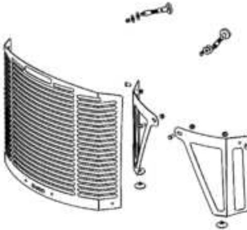
**es** - Sacaremos la pantalla del embalaje y quitaremos los tornillos M-6 de sus posiciones hasta que nos queden liberadas las dos patas.
