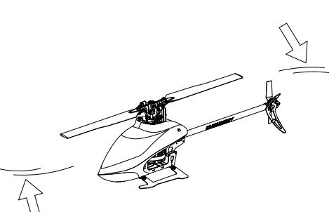
当直升机主旋翼与尾旋翼运转时，切勿触摸并远离任何物件，以避免造成危险及损坏。
