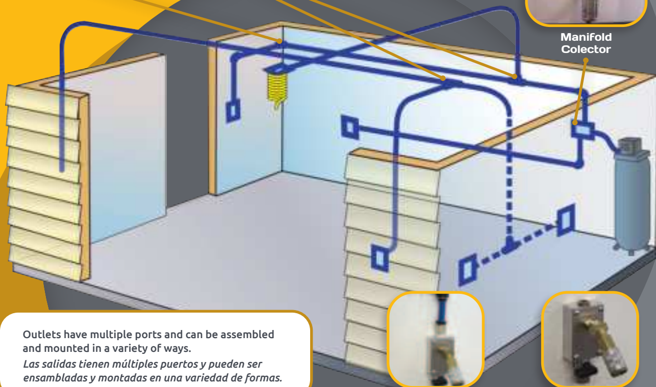
Surface Mount Montaje en Superficie Air line is mounted to wall La línea de aire está montada en la pared
