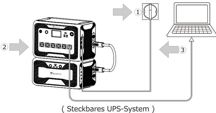
Schritt1: Bitte stecken Sie das AC-Ladekabel in die Steckdose.
