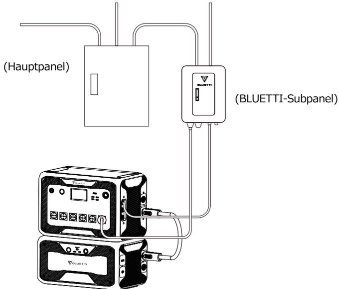
( Das netzgesicherte Heim-Ersatzstromversorgungssystem der AC300 )
