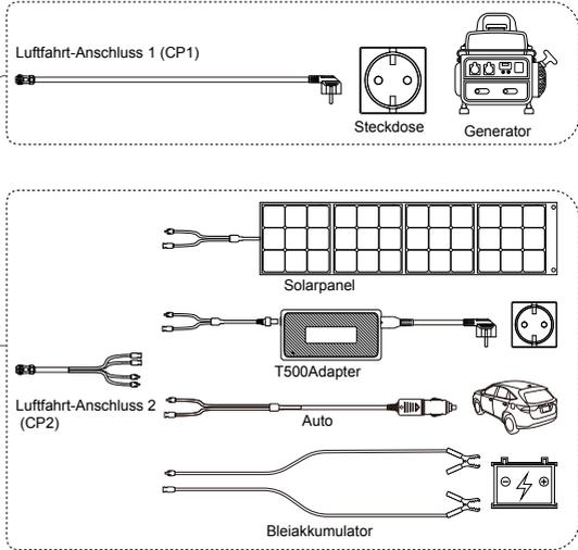
Lademethode 5: Sie können alle zuvor aufgeführten Lademethoden gleichzeitig verwenden, um die Ladeleistung zu maximieren. Sie sind nachfolgend in einer Übersicht aufgeführt. Wählen Sie eine Methode für CP1 und eine Methode für CP2 für das gleichzeitige Laden.
