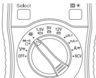
3. Conecte el capacitor: conecte el cable de prueba rojo con la polaridad positiva del capacitor y conecte el cable de prueba negro con la polaridad negativa.
