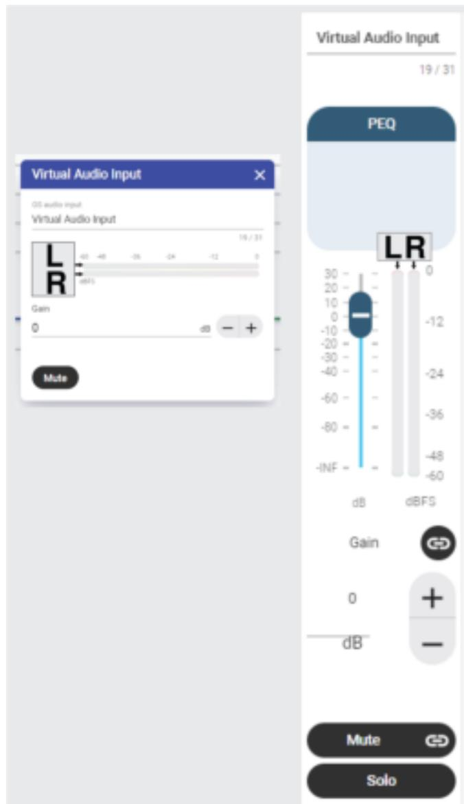
En la lista de entrada de la mezcladora de matriz, hay una señal de entrada de audio virtual izquierdo y una señal de entrada de audio virtual derecho. De forma predeterminada, estas se envían a las salidas 1 y 2 Dante.
