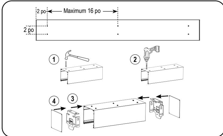
En utilisant un crayon, marquez les endroits pour les trous de vis. Utilisez un poinçon au centre sur les endroits marqués. Pré-percez les trous de montage pour les vis en utilisant un foret de  $\frac{1}{8}$  po. Insérez le support dans le caisson (vous aurez peut-être besoin d'un maillet pour taper doucement le support en place) jusqu'à ce qu'il soit encastré avec le bout du caisson. Sécurisez les plaques d'extrémité dans le support en utilisant les vis fournies.
