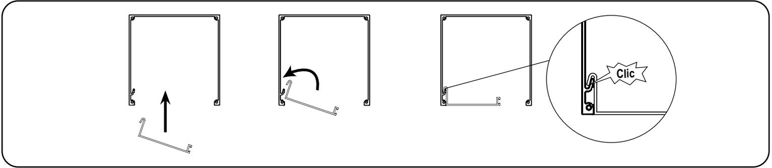
Pour installer, insérez la fermeture inférieure dans le caisson sur un angle, accrochez sur le devant du caisson. Une fois que ce soit aligné, permettez soigneusement la fermeture inférieure de tomber en place.
