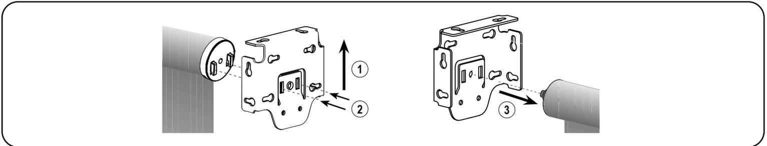
Pour commencer, suivez les étapes pour retirer la fermeture inférieure. Ensuite, soulevez doucement l'unité de contrôle (côté du crochet) pour désengager, jusqu'à ce que les crochets touchent le haut de la fente du support. Tirez le store vers l'épingle à ressort jusqu'à ce que les crochets soient complètement hors des fentes du support. Finalement, retirez le côté de l'épingle à ressort du support inactif.
