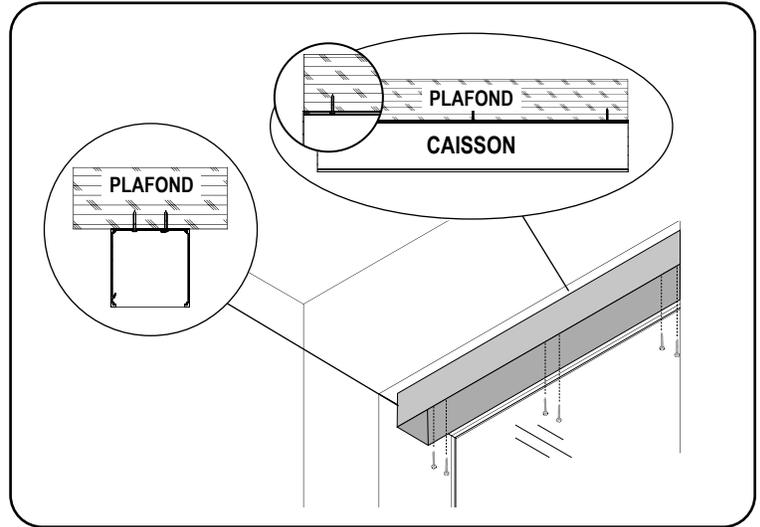
En respectant les trous pré-perçés, montez le caisson au plafond en utilisant les vis de montage appropriées.
