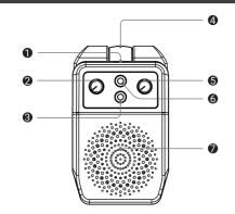
①Type-C充电接口: 用包装盒内的Type-C充电线给产品充 电,红灯常亮代表正在充电,红灯熄灭代表已充满电,建 议使用5V2A充电器为产品充电。
