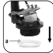
**B: INSÉRER LE ROBINET DE CHASSE DANS LE TROU DU RÉSERVOIR.**
