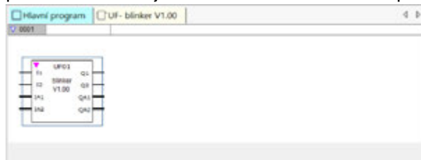
Obr. 277: V hlavním programu použitý uživatelský modul UF blikáči
