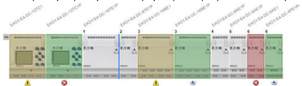
Obr. 312: Náhled projektu ONLINE s různě zabarvenými přístroji podle kompatibility
