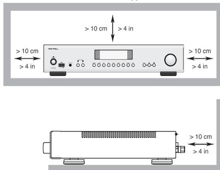
**ATTENTION :** La prise d'alimentation située à l'arrière constitue le principal moyen pour déconnecter l'appareil du secteur. Cet équipement doit être positionné dans un espace ouvert qui permet de garder l'accès au câble d'alimentation.
