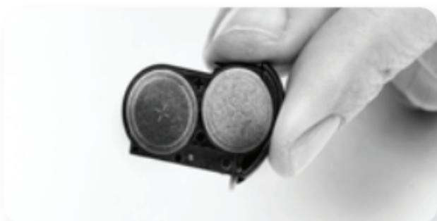
Als de batterijen gelijk liggen met de bovenkant van de batterijlade, schuif dan de batterijlade voorzichtig terug in de batterijcartridge. Als de batterijen verkeerd geplaatst zijn, gaat de batterijlade niet dicht.
