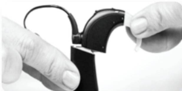
Alignez le connecteur du compartiment pile et le côté arrière du processeur sur le processeur.
