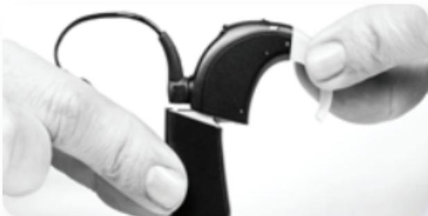
Allineare il connettore del vano batteria con il lato del connettore del processore sonoro situato in corrispondenza dell'involucro.
