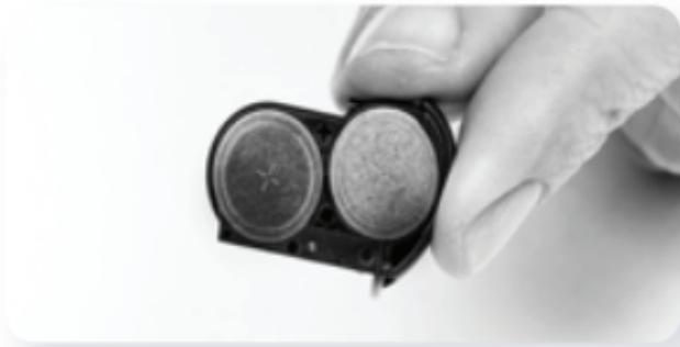
Quando le batterie sono a filo con la parte superiore del cassetto, far scorrere delicatamente il cassetto all'interno del vano batteria. Se le batterie non sono inserite correttamente, il cassetto non si chiude.
