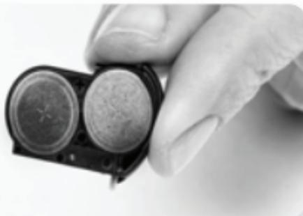
Una vez que las baterías estén alineadas con la parte superior del compartimento, deslice con suavidad el compartimento para baterías nuevamente al interior del paquete de baterías. Si las baterías no se insertan correctamente, el compartimento de la batería no se cerrará.
