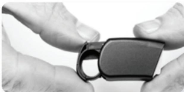
Retire las celdas de la batería de zinc-aire del envase, asegurándose de quitar el adhesivo del lado positivo (+) plano de la celda. Al retirar el adhesivo, se permite el ingreso de aire y la activación de la batería, por lo que debe asegurarse de utilizar la batería inmediatamente después de despegar el adhesivo.
