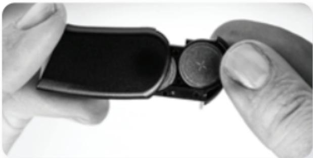
Schließen Sie nun den Batterieeinsatz an den Naída CI an. Halten Sie dazu den Soundprozessor in einer Hand. Drehen Sie den Stecker des Überträgerkabels nach oben, um den Batterieeinsatz ungehindert anschließen zu können.
