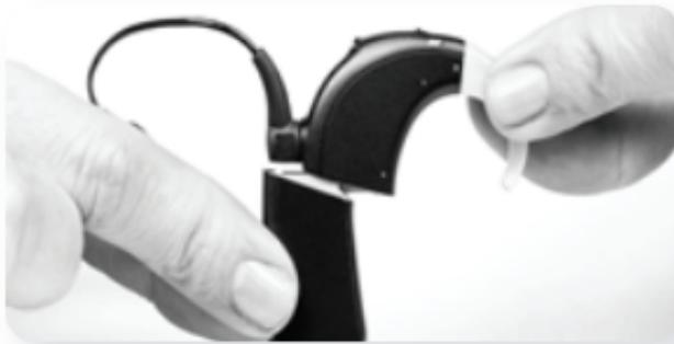
Richten Sie den Anschluss des Akkus/Batterieeinsatzes am Anschluss des Prozessormoduls aus.
