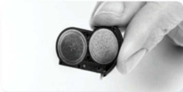
Une fois les piles en contact avec le haut du logement, faites doucement glisser le tiroir pile dans le compartiment pile. Si les batteries sont mal insérées, le boîtier ne se refermera pas.
