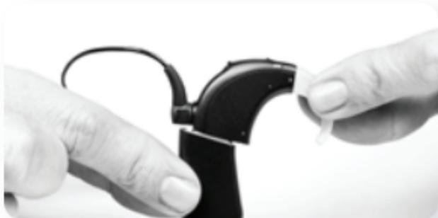
Schieben Sie den Batterieeinsatz auf den Prozessor auf, bis er einrastet.
