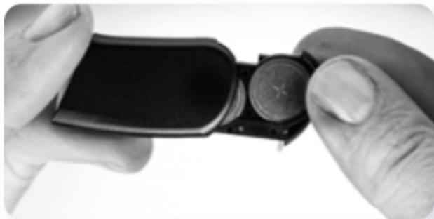
Procedere quindi a collegare il vano batteria al Naída CI tenendo il processore sonoro in una mano. Girare il cavo RF verso l'alto per evitare di urtarlo durante il posizionamento della batteria.
