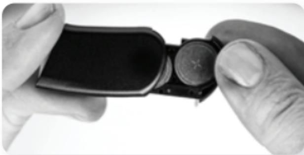
Daarna komt het bevestigen van de batterijcartridge aan de Naída CI, houd hiervoor de spraakprocessor in de ene hand. Roteer de zendspoelkabel naar boven om er niet tegenaan te stoten bij het vervangen van de batterij.
