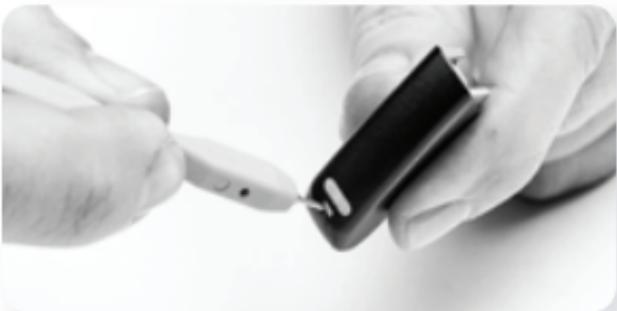
Schieben Sie das Werkzeug vorsichtig vor und nach unten, bis sich der Zink-Luft-Batterieeinsatz an der Unterseite des Zink-Luft-Batterieeinsatzes öffnet. Wenn Sie das Werkzeug nicht zur Hand haben, können Sie das Batteriefach auch mit einem anderen dünnen, spitzen Gegenstand öffnen.
