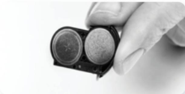
Una vez que las baterías estén alineadas con la parte superior del compartimento, deslice con suavidad el compartimento para baterías nuevamente al interior del paquete de baterías. Si las baterías no se insertan correctamente, el compartimento de la batería no se cerrará.
