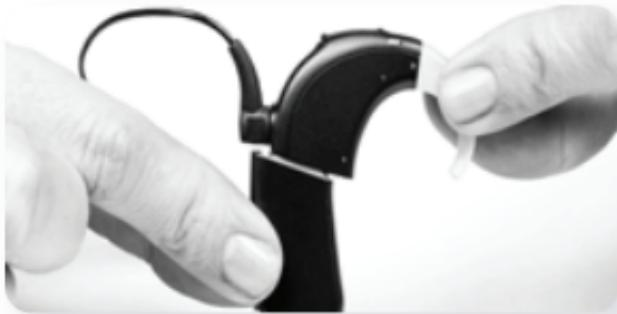
Faites glisser le compartiment pile dans le processeur jusqu'à ce qu'il s'emboîte.
