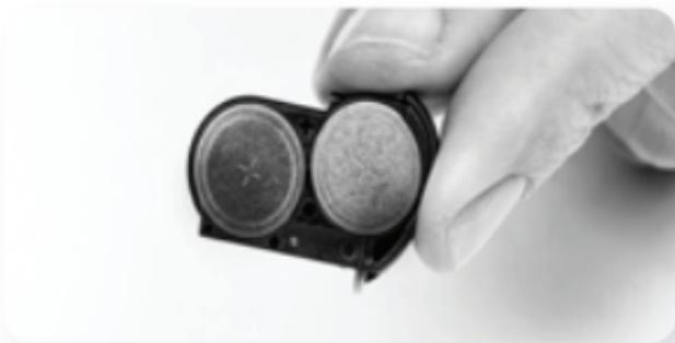
Quando le batterie sono a filo con la parte superiore del cassetto, far scorrere delicatamente il cassetto all'interno del vano batteria. Se le batterie non sono inserite correttamente, il cassetto non si chiude.
