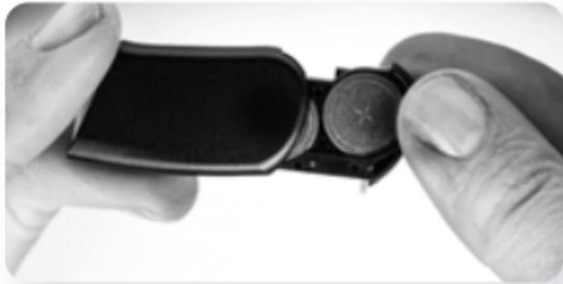
Fixez ensuite le compartiment pile au Naída CI en tenant le processeur de son d'une main. Faites tourner le cordon d'antenne vers le haut afin d'éviter de le heurter lors de la mise en place du compartiment.
