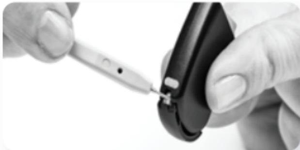
Deje la herramienta a un lado. Ahora, puede tomar el compartimento de baterías de zinc-aire con la mano y tirar de él suavemente para terminar de abrirlo, de modo que pueda insertar las celdas de zinc-aire.
