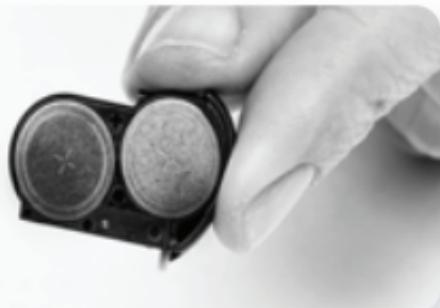
Als de batterijen gelijk liggen met de bovenkant van de batterijlade, schuif dan de batterijlade voorzichtig terug in de batterijcartridge. Als de batterijen verkeerd geplaatst zijn, gaat de batterijlade niet dicht.
