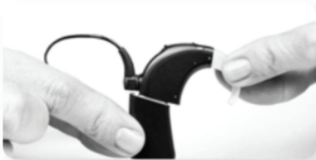
Schuif de batterij op de processor tot u voelt dat deze vastklikt.
