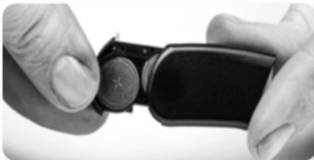
Luego, comience a conectar el paquete de baterías al Naída CI sosteniendo el procesador de sonido con una mano. Rote el cable de RF hacia arriba para evitar golpearlo al colocar la batería.
