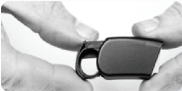
Estrarre le batterie zinco-aria dalla confezione, accertandosi di rimuovere l'adesivo dal lato positivo piatto (+) della batteria. La rimozione dell'adesivo consente all'aria di entrare e di attivare la batteria, perciò è necessario usare la batteria subito dopo aver staccato l'adesivo.
