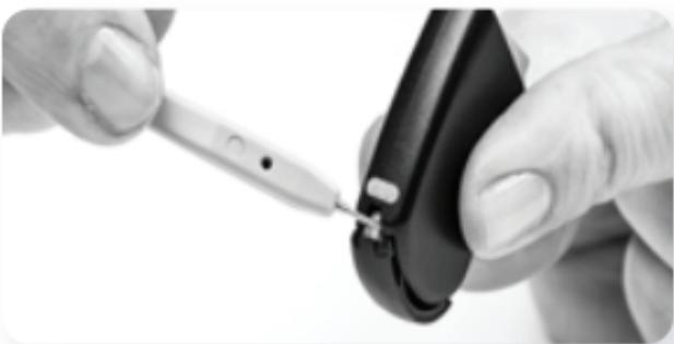
Legen Sie nun das Werkzeug beiseite. Ziehen Sie jetzt das Zink-Luft-Batteriefach mit der Hand vorsichtig vollständig aus dem Batterieeinsatz heraus, um an die Zink-Luft-Batterien zu gelangen.
