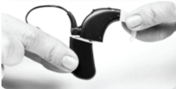
Allineare il connettore del vano batteria con il lato del connettore del processore sonoro situato in corrispondenza dell'involucro.
