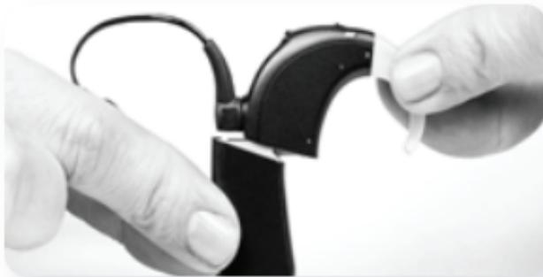
Alinee el conector del paquete de baterías con el lado del conector de la carcasa del procesador.
