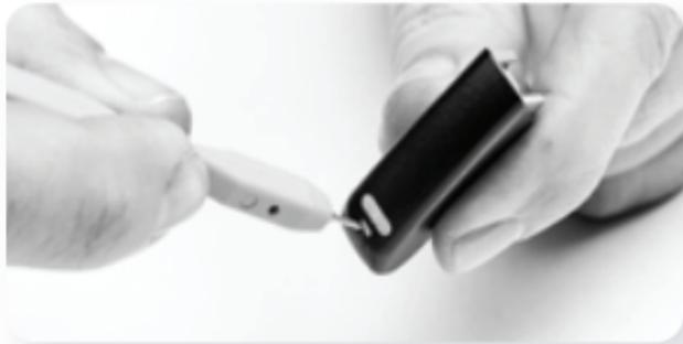
Con lo strumento inserito nel foro, premere delicatamente verso l'interno e verso il basso finché non si sente che il cassetto della batteria zinco-aria si sgancia e che il pulsante del vano batteria zinco-aria esce fuori. Se non si dispone dello strumento, qualunque dispositivo appuntito dovrebbe permettere di estrarre il cassetto.
