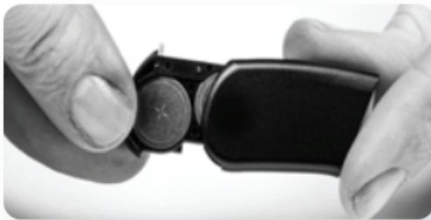
Schließen Sie nun den Batterieeinsatz an den Naída CI an. Halten Sie dazu den Soundprozessor in einer Hand. Drehen Sie den Stecker des Überträgerkabels nach oben, um den Batterieeinsatz ungehindert anschließen zu können.
