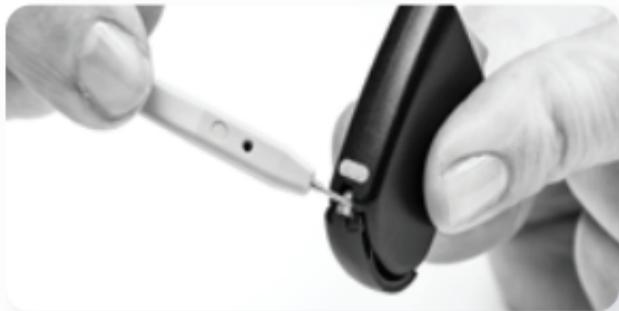
Mettere via lo strumento. A questo punto è possibile afferrare con la mano il cassetto della batteria zinco-aria e tirarlo fuori del tutto delicatamente, in modo da potervi inserire le batterie zinco-aria.
