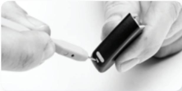
Con la herramienta insertada en el orificio, empuje suavemente hacia adentro y abajo, hasta sentir que el compartimento de baterías de zinc-aire se libera y sale por la parte inferior del paquete de baterías de zinc-aire. Si no dispone de la herramienta, cualquier elemento fino y con punta servirá para liberar el compartimento.
