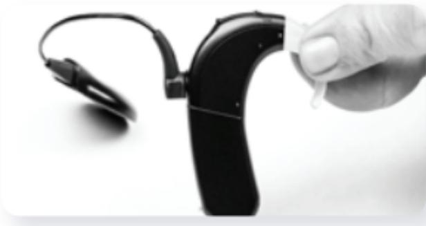
***Inserimento delle batterie zinco-aria monouso
