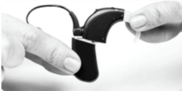
Richten Sie den Anschluss des Akkus/Batterieeinsatzes am Anschluss des Prozessormoduls aus.
