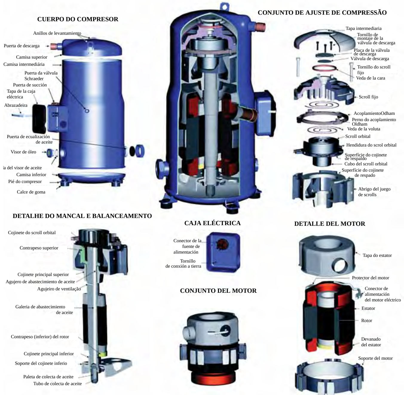
Figura 9. Componentes internos del compresor en unidades de 10-15 TR
