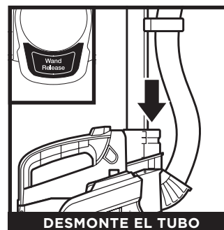
DESMONTE EL TUBO
