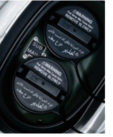
فتحتا وقود مزدوجتان Double filler tubes
