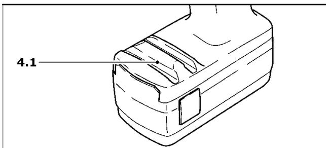
En el alojamiento para destornilladores (4.1) se pueden meter lateralmente dos destornilladores o adaptadores para destornillador.
