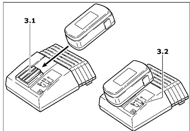
Para cargar es preciso empujar el acumulador hasta el tope en el soporte (3.1) del cargador. En dirección opuesta, el acumulador cargado puede extraerse del cargador.
