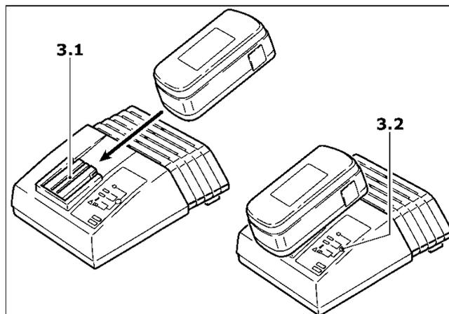
Pour le chargement, vous devez pousser la batterie dans le logement (3.1) du chargeur jusqu'à la butée. A l'inverse, il est possible de retirer la batterie chargée du chargeur.
