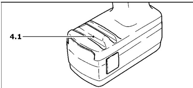
Dans le porte-embouts (4.1), il est possible d'insérer latéralement plusieurs embouts ou rallonges pour embouts.
