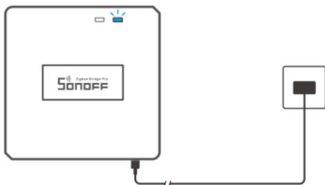
使用 Micro USB 线给设备通电。通电后, 设备首次使用, 默认进入配网模式, Wi-Fi 指示灯呈“两短一长闪烁”。
