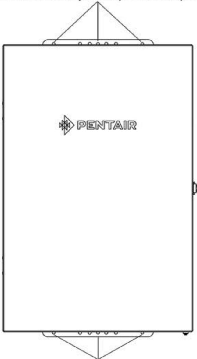
Orificios para tornillos en la parte inferior del soporte
