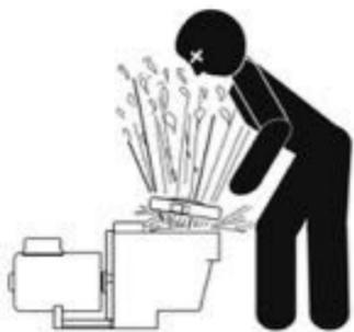
**PRESIÓN PELIGROSA: MANTÉNGASE ALEJADO DE LA BOMBA Y DEL FILTRO DURANTE EL ARRANQUE**
