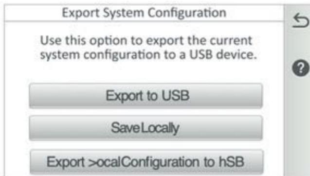
«**Export System Configuration**» (**Exportar configuración del sistema**): pulse «Export to USB» (Exportar a un USB) para exportar la configuración del sistema actual.
