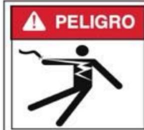
**PARA EVITAR RIESGOS ELÉCTRICOS:** no conecte los conductores de la fuente de alimentación al interruptor del centro de carga hasta que se hayan completado todas las conexiones eléctricas de todas las cargas (calentadores, bombas, válvulas motorizadas, iluminación, etc.).
