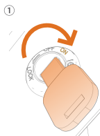
Włączyć akumulator kluczem
