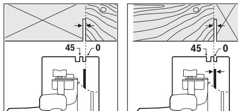
Le marquage de coupe 0° (10) indique la position de la lame de scie lors d'une coupe à angle droit. Le marquage de coupe 45° (9) indique la position de la lame de scie lors d'une coupe à angle de 45°.
