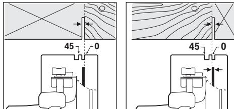
เครื่องงหหมายตัด  $0^\circ$  (**10**) และดึงตัวแทนงของใบเลื่อยสำหรับการตัดเป็นมุมฉาก เครื่องงหหมายตัด  $45^\circ$  (**9**) และดึงตัวแทนงของใบเลื่อยสำหรับการตัด  $45^\circ$  เพื่อให้ได้การตัดที่แม่นยำ ให้จับเลื่อยวงเดือนข้าหาชิ้นงานดังแสดงในภาพ ทางที่ต้องการตัดที่สุดควรฝึกซ้อมการตัดก่อน
