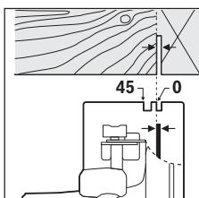
A marcação de corte 0° (10) indica a posição do disco de serra num corte em ângulo reto. A marcação de corte 45° (9) indica a posição do disco de serra num corte num ângulo de 45°.
