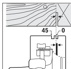
Tanda pemotongan 0° (10) menunjukkan posisi mata gergaji pada pemotongan persegi. Tanda pemotongan 45° (9) menunjukkan posisi pada mata gergaji pemotongan 45°. Untuk melakukan pemotongan yang tepat, dekatkan mesin gergaji bundar pada benda kerja seperti terlihat pada gambar. Sebaiknya dilakukan uji coba pemotongan dahulu.
