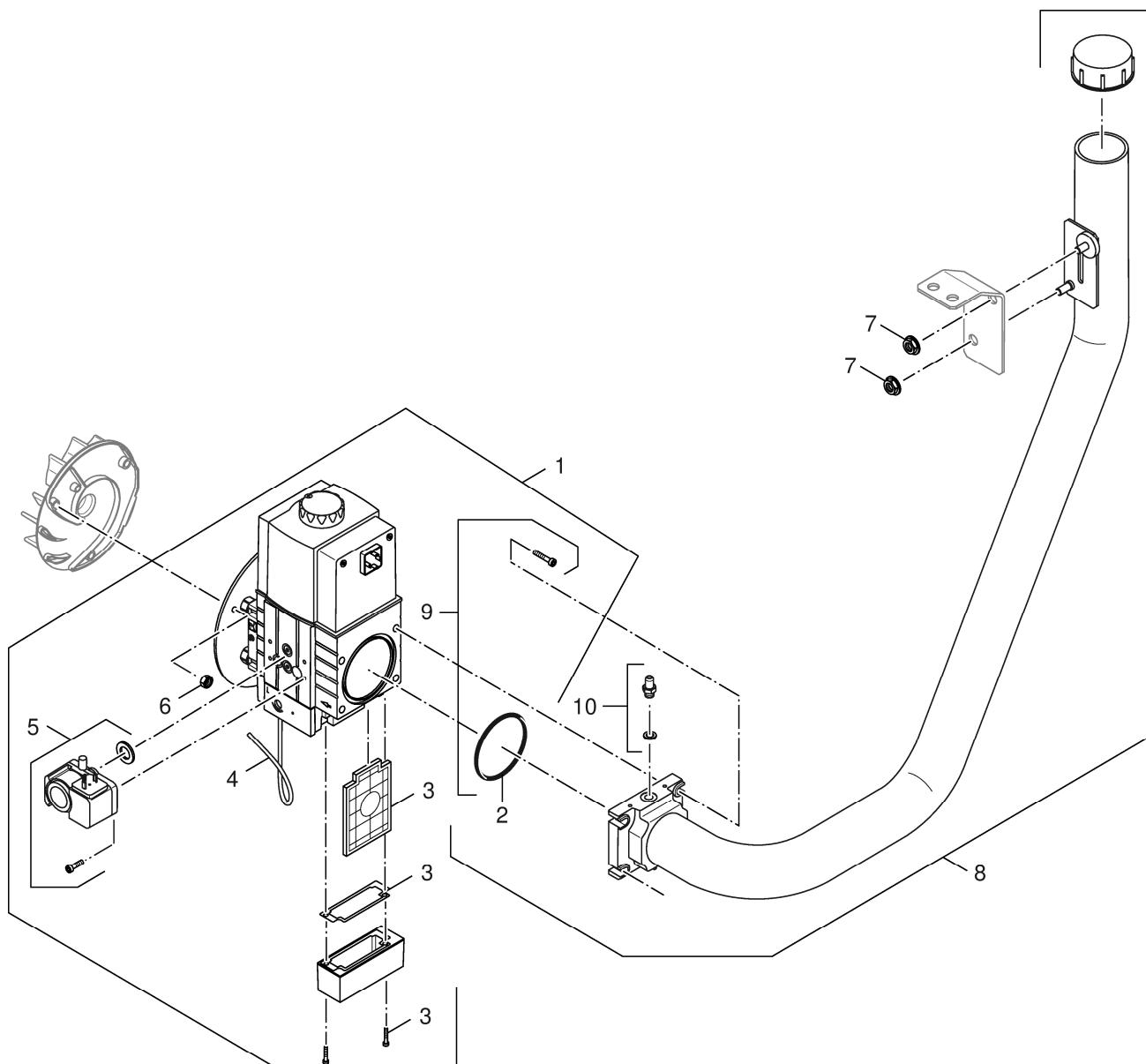
6720905681.aa.RS-Gasarmatur, Gasanschlussrohr VM402
