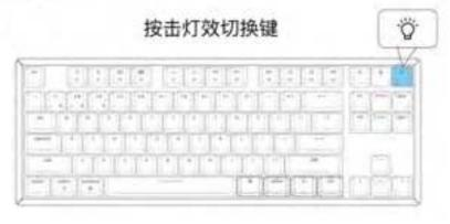
RGB版本、按击fn和左右方向键来切换背光的颜色。 (适用于静态颜色模式)
