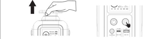
Ziehen Sie das Teleskoplicht hoch, es kann in mehreren Winkeln eingestellt werden, drücken Sie lange auf die Einschalttaste, um es einzuschalten, und klicken Sie auf die Beleuchtungstaste, um es zu verwenden. Klicken Sie erneut, um die Modi zu wechseln (Normal, Höher, Blinkend, SOS). Wenn Sie das Licht ausschalten möchten, drücken Sie bitte erneut auf die Taste. Im ausgeschalteten Zustand können Sie durch langes Drücken der Lichttaste auch die LED-Beleuchtung einschalten.
