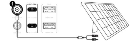
1.Verbinden Sie es mit dem Ausgangsanschluss des Solarpanels, stecken Sie es in den DC-Eingangsanschluss Nr. 1, unterstützt 20~60V, 140W . Eingangsleistung.( \*DC7909-Patchkabel ist optional)
