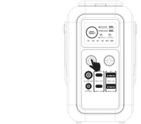
Halten Sie den Netzschalter 3 Sekunden lang gedrückt, der Bildschirm leuchtet auf und Sie können auf die entsprechende Schnittstelle zugreifen, um das Gerät mit Strom zu versorgen. Dieses Produkt unterstützt eine maximale Leistung von 200W.
