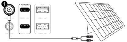
1.Verbinden Sie es mit dem Ausgangsanschluss des Solarpanels, stecken Sie es in den DC-Eingangsanschluss Nr. 1, unterstützt 20~60V, 140W . Eingangsleistung.( \*DC7909-Patchkabel ist optional)
