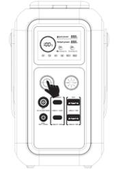
Halten Sie den Netzschalter 3 Sekunden lang gedrückt, der Bildschirm leuchtet auf und Sie können auf die entsprechende Schnittstelle zugreifen, um das Gerät mit Strom zu versorgen. Dieses Produkt unterstützt eine maximale Leistung von 200W.
