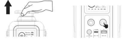
Ziehen Sie das Teleskoplicht hoch, es kann in mehreren Winkeln eingestellt werden, drücken Sie lange auf die Einschalttaste, um es einzuschalten, und klicken Sie auf die Beleuchtungstaste, um es zu verwenden. Klicken Sie erneut, um die Modi zu wechseln (Normal, Höher, Blinkend, SOS). Wenn Sie das Licht ausschalten möchten, drücken Sie bitte erneut auf die Taste. Im ausgeschalteten Zustand können Sie durch langes Drücken der Lichttaste auch die LED-Beleuchtung einschalten.
