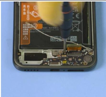
8. Fije el conector FPC BTB del sensor de huellas digitales.
