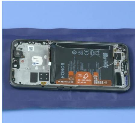
2. Utilice las pinzas metálicas de punta plana para sacar el receptor de la abertura de extracción. Retire el receptor.
