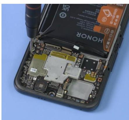
3. Fije el conector FPC BTB principal en el lado de la PCBA. Fije el conector FPC BTB LCD.
