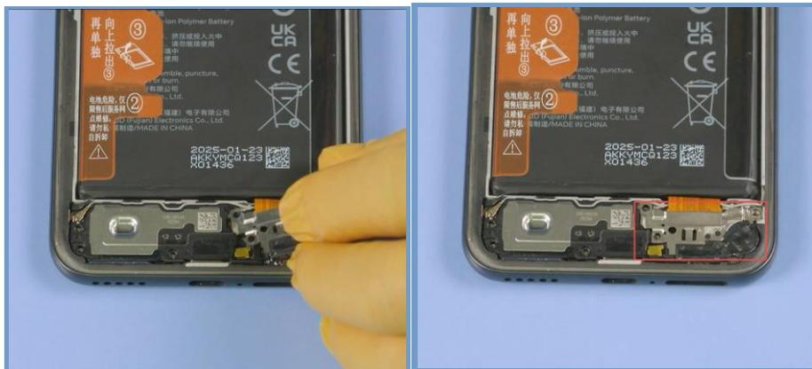
12. Use la punta de destornillador Phillips para apretar los tornillos M1,4.
