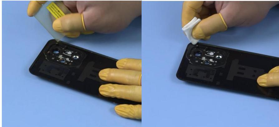
7. Utilice el borrador de adhesivo para eliminar el adhesivo residual curado del soporte de PCBA, el soporte de la subplaca, el altavoz y el marco intermedio; use un paño sin pelusa humedecido en una pequeña cantidad de alcohol para eliminar el adhesivo residual.
