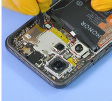
7. Utilice las pinzas de plástico para rasgar la tela conductora del conector BTB de las cámaras frontal y principal.
