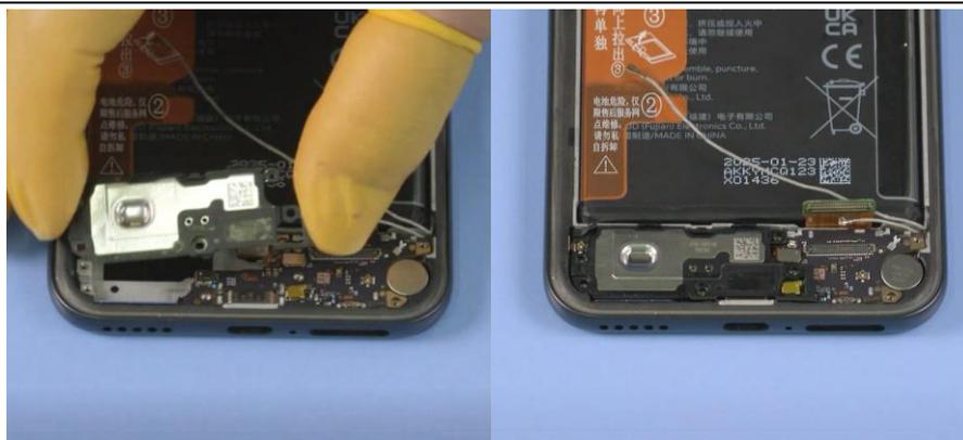
9. Fije el cable coaxial en el lateral de la placa secundaria; conecte el cable coaxial largo al enchufe hembra de la placa auxiliar; introduzca el cable coaxial largo en su ranura.
