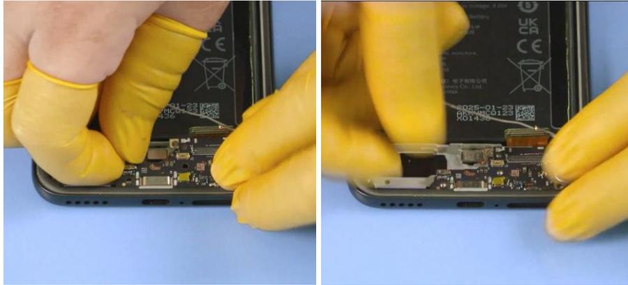
4. Use la punta de destornillador Phillips para apretar 1 tornillos M1,2.
