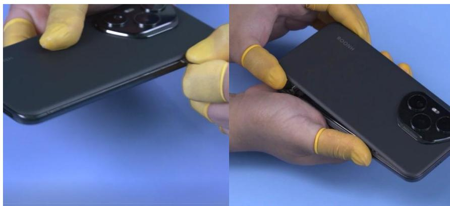
5. Elimine todo el adhesivo de la cubierta trasera.
