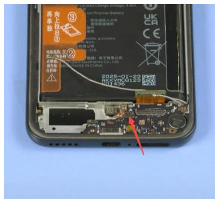
6. Aplique adhesivo al área de la subplaca auxiliar; retire la película protectora del adhesivo;
