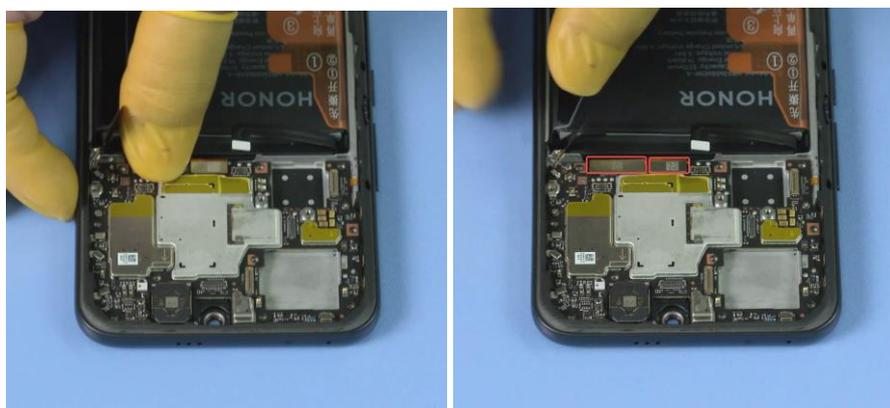
4. Utilice las pinzas de plástico para instalar el conector del cable coaxial en el enchufe hembra.
