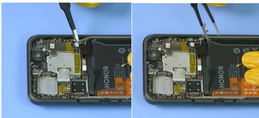
11. Use la punta de destornillador Phillips para retirar los 2 tornillos M1,2 de la PCBA.
