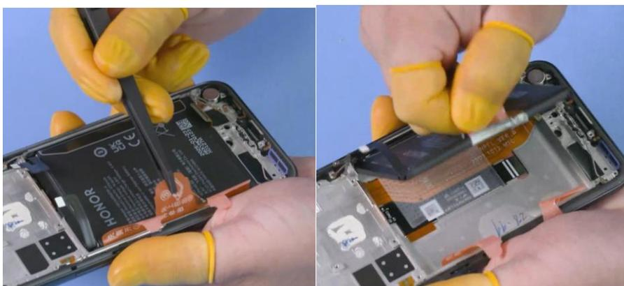
12. Elimine el adhesivo de la batería; utilice el borrador de adhesivo para eliminar el adhesivo residual; verifique que la superficie del compartimiento de la batería esté libre de objetos extraños.
