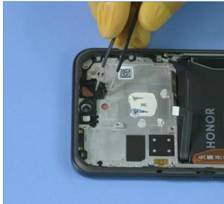
4. Instalar el sensor de huellas digitales: Aplique adhesivo en el área del sensor de huellas digitales, en el orificio de la cubierta frontal. Inserte el sensor de huellas dactilares en el orificio del sensor de huellas dactilares de la cubierta frontal.
