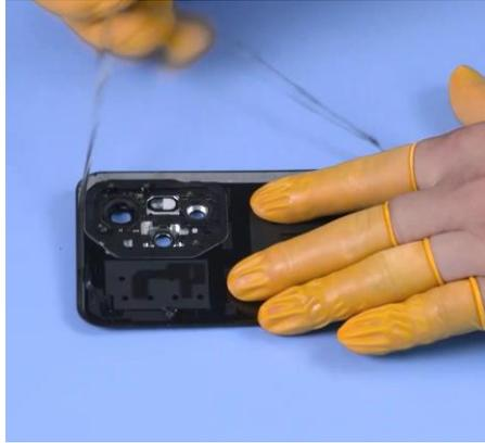
6. Utilice el borrador de adhesivo para eliminar el adhesivo residual; use un paño sin pelusa humedecido en una pequeña cantidad de alcohol para eliminar el adhesivo residual.
