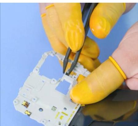
6. Retire los dos conectores BTB de la batería.
