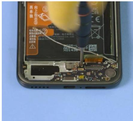
5. Fije el conector FPC BTB del sensor de huellas digitales.
