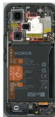
9. Retire todas las cámaras, retire los soportes de las cámaras.
