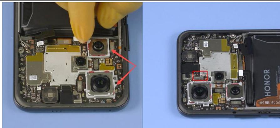
8. Aplique adhesivo al área de la subplaca flash. Retire la película protectora del adhesivo.
