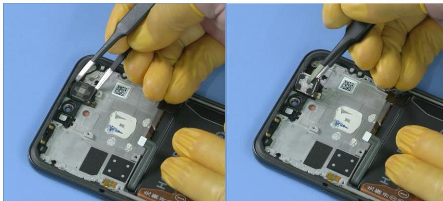
3. Elimine el adhesivo de la espuma de sellado del receptor.
