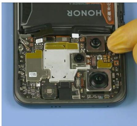
7. Instale el soporte de fijación de la cámara y coloque la tela conductora de la cámara posterior principal.
