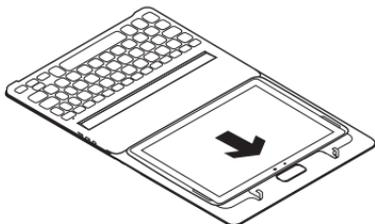
2. 在平板電腦固定座下方，使用兩條橡皮筋將平板電腦固定到位：
