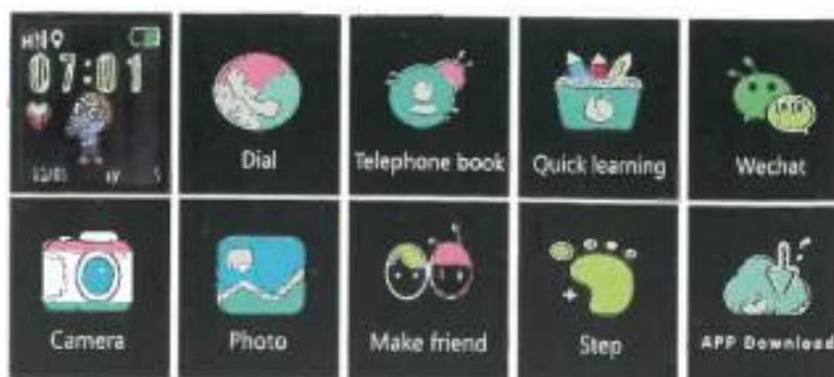
**Interface principale :** La petite icône de la première ligne correspond au signal GSM, au mode de sonnerie, à la marque de mise en réseau, à l'icône de positionnement, à la marque de voix (non marquée dans le schéma), à la marque de batterie, en dessous se trouvent l'heure et la date.
