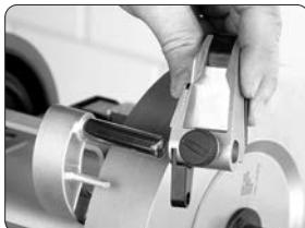
*Retirer le dispositif pour couteaux de la machine et le remplacer par le RBS-140 dispositif d'affûtage des lames rondes (ci-après dénommé «accessoire»).*
