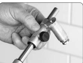
*Définir la taille en desserrant la vis d'arrêt du guide et la faire glisser jusqu'à la taille souhaitée. Resserrer la vis d'arrêt pour la bloquer.*
