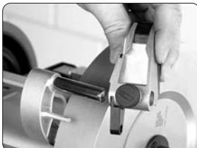
Vorrichtung für Messer von der Maschine entfernen und durch die RBS-140 Vorrichtung für Rundmesser (im Folgenden „Zubehör“) ersetzen.
