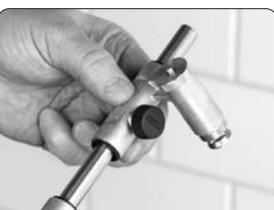
Ställ in storleken genom att lossa stoppskruven till styrningen och skjut den till önskad storlek. Dra åt stoppskruven igen för att låsa.
