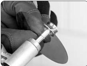
Enfiler le tendeur dans le trou de la lame avec le biseau contre l'extrémité épaisse. Remettre le tendeur et la lame en place dans le guide.
