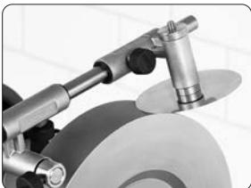
Zubehör so herunterklappen, dass die Scheibenschleifphase an der Diamantschleifscheibe anliegt. Danach die Maschine starten. Nun wird die Scheibe geschliffen.
