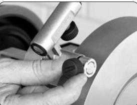
Ta loss den medföljande stopp-ringen och fäst den på maskinens axel intill tillbehöret för att hålla det på plats.
