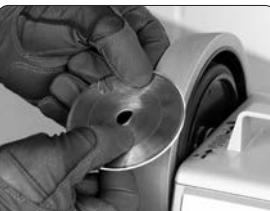
**⚠ Utiliser des gants de protection pour éviter les blessures par objets tranchants! Veiller à ce que le disque de démorphilage tourne à partir du bord, sinon la lame coupera dans le disque de démorphilage.**
