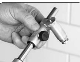
Zur Einstellung der Größe die Anschlagschraube der Führung lösen und die Führung zur gewünschten Größe schieben. Zum Fixieren Anschlagschraube wieder anziehen.
