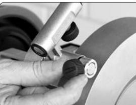
Den mitgelieferten Anschlagring abnehmen und auf der Maschinenachse neben dem Zubehör befestigen, um das Zubehör zu fixieren.
