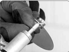
Den Spanner durch das Scheibenloch führen, dabei zeigt die Schleipphase zum dicken Ende hin. Spanner und Scheibe wieder in die Führung montieren.
