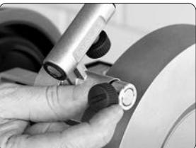
*Retirer la bague d'arrêt jointe et la fixer sur l'arbre de la machine à côté de l'accessoire pour le maintenir en place.*
