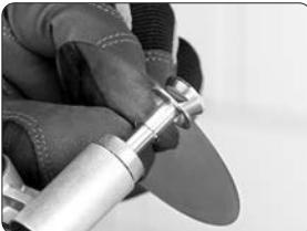
Trä spänningen genom bladhålet med slipfasen mot den tjocka änden. Sätt tillbaka spänningen och bladet i styrningen.
