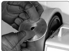
**⚠️** Schutzhandschuhe tragen, um Schnittverletzungen zu vermeiden! Achten Sie darauf, dass sich die Abziehscheibe **von der Schneide wegdreht**, da sonst die Scheibe in die Abziehscheibe schneidet.
