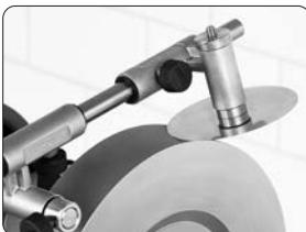
Rabattre l'Accessoire de manière à ce que le biseau de la lame soit en contact contre la meule diamantée et démarrer la machine. L'affûtage de la lame est maintenant en cours.
