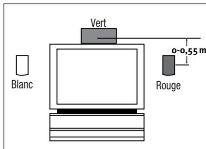
L'enceinte "voie centrale" doit être placée légèrement derrière et à peu près au même niveau que les enceintes droite et gauche. Il est souvent pratique de placer la voie centrale sur le dessus de la télévision comme indiqué sur la figure.
