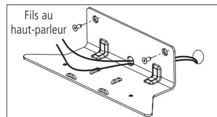
Placez la fixation de manière à ce que l'orifice du câble se situe devant le trou mural de sortie du câble. Faites passer le câble à travers l'orifice et fixez la fixation au mur.
