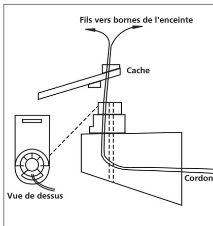
La console présente deux ouvertures sur le dessus : un trou à vis rond, et une ouverture en arc de cercle. Passer le cordon dans cette dernière, non dans le trou de vis.
