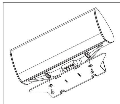
La fixation murale ne peut pas pivoter latéralement. La fixation n'est pas conçue pour s'incliner vers le bas ou le haut et une tentative en ce sens pourrait endommager la fixation, ainsi qu'éventuellement le mur, ce qui ne serait pas couvert par la garantie.
