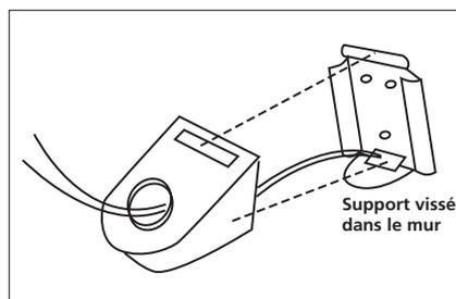
Insérer le boulon par le bas de la console et l'ouverture du cache pour le visser dans le trou fileté. Exercer un couple de serrage qui assure la fixation sans empêcher la console de pivoter.
