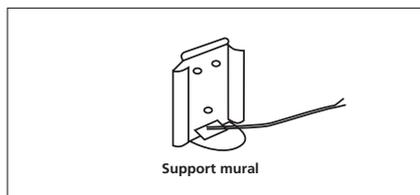
Monter le support de la console sur le mur à l'endroit approprié.
