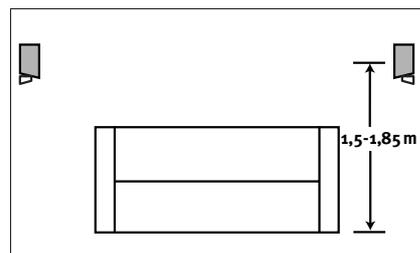
Les deux enceintes "surround" doivent être placées face à face légèrement derrière la zone d'écoute. Si ce n'est pas possible, elles peuvent être placées sur un mur derrière la zone d'écoute, tournées vers l'avant. Les enceintes d'ambiance acoustique ne doivent pas attirer l'attention: cherchez leur place jusqu'à ce que vous entendiez un bruit ambiant diffus qui accompagne le programme principal diffusé par les enceintes avant.
