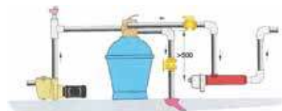
Ejemplo de instalación para calentamiento de piscinas
