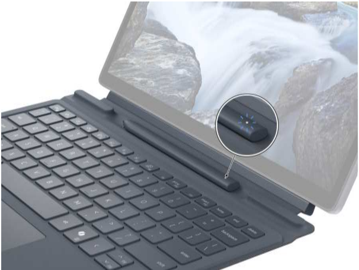
Figure 12. Charging the Latitude 7350 Detachable Active Pen
