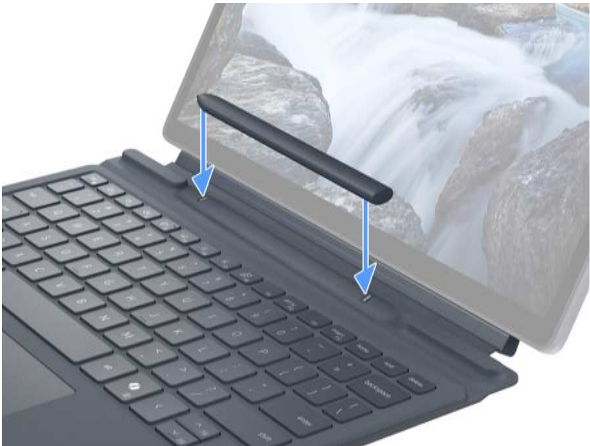
Figure 11. Docking the Latitude 7350 Detachable Active Pen
