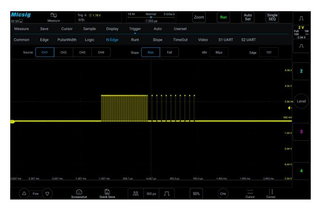
图 6-1 Figure 6-23 Nth Edge Trigger Menu
