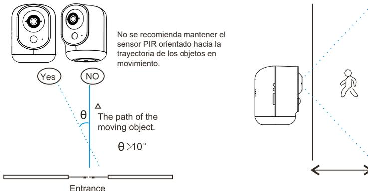
Al instalar la cámara, el sensor PIR no debe estar alineado verticalmente con objetos móviles, ya que podría no detectar el movimiento. Se recomienda que la cámara tenga una inclinación de más de 10 grados para captar todo el movimiento.
