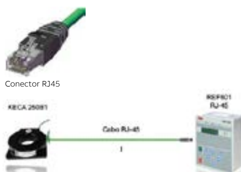
Exemplo: Ligação direta de conectores entre o sensor e a família IED
