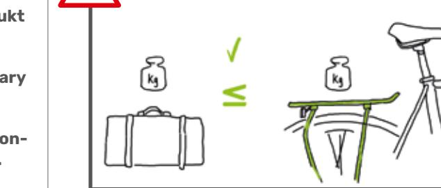
Max. Zuladung | Max. load | Charge max. | Max. belastning | Carga máx. | Carico max.
