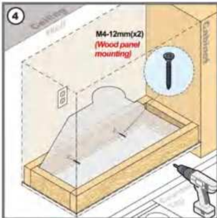
(4) Die Dunstabzugshaube durch die Montagelöcher führen und mit Holzschrauben auf dem Holzklötz befestigen.
