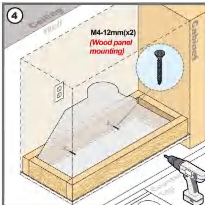
(4) Fäst spiskåpan genom installationshålen med träskruvar för att montera den på träblocket.
