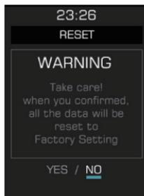
Le kilométrage partiel est remis à zéro après l'effacement des données, la vitesse moyenne et la vitesse maximale sont également remises à zéro ; la valeur ODO du kilométrage cumulé n'est effacée par aucune opération sur l'écran, elle nécessite un outil de maintenance professionnel pour être effacée
