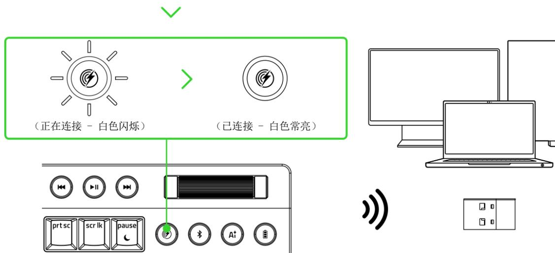
你的键盘现已可以使用 Razer HyperSpeed Wireless 无线模式 (2.4 GHz)。
