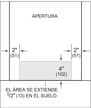
Ubicación del suministro de agua
