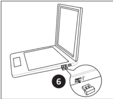
**AVISO** El nanoreceptor se empareja automáticamente con el producto. Si la conexión falla o se interrumpe, apague el producto y vuelva a conectarlo.
