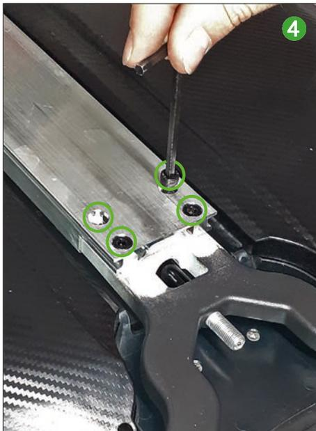
Avec une clé six pans de  $\varnothing 4$  , dévissez les 4 vis assemblant le rail et le trolley (photo **4** ).
