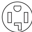
Tomacorriente de 4 hilos (14-30R)
