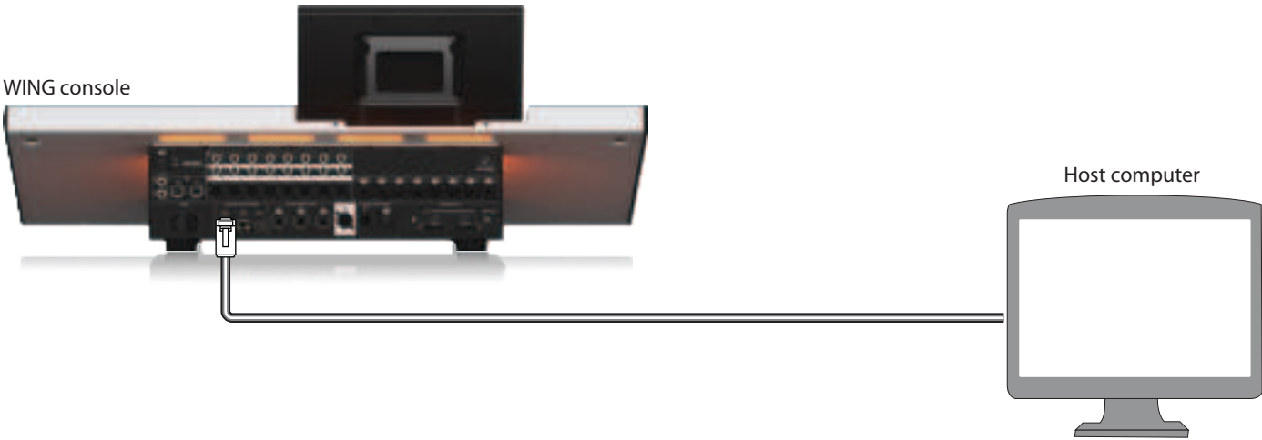
Abb. 1: Direkte Verbindung zwischen WING und Host-Computer
