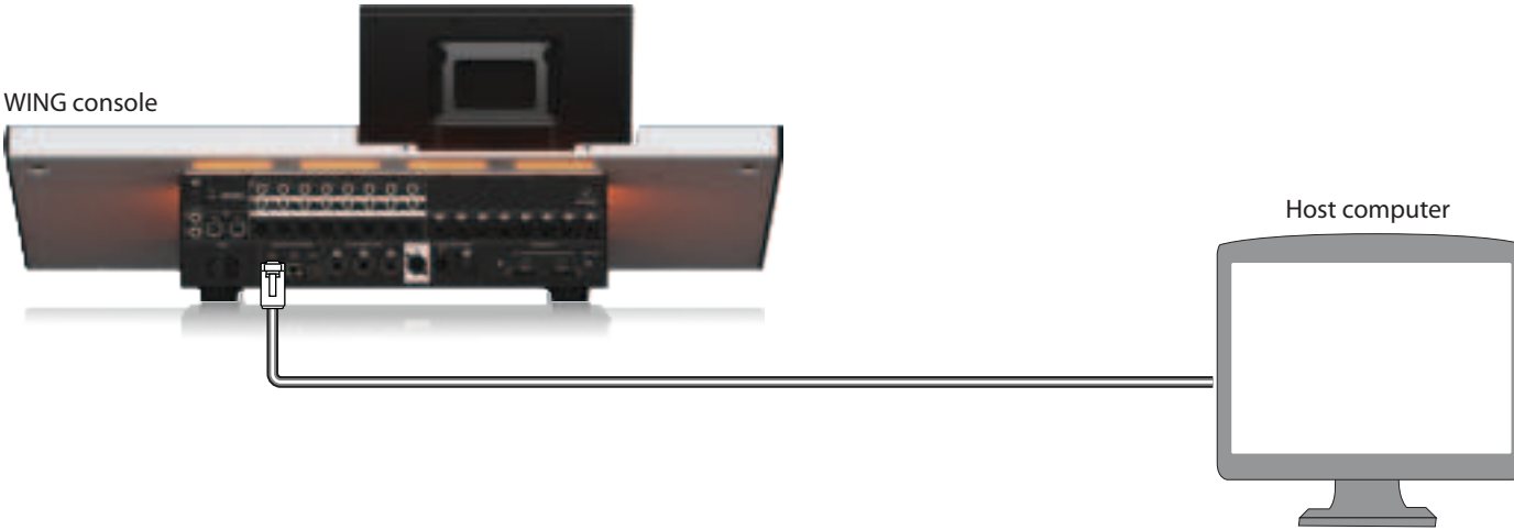
Fig. 1: Direkt anslutning mellan WING och värd-dator
