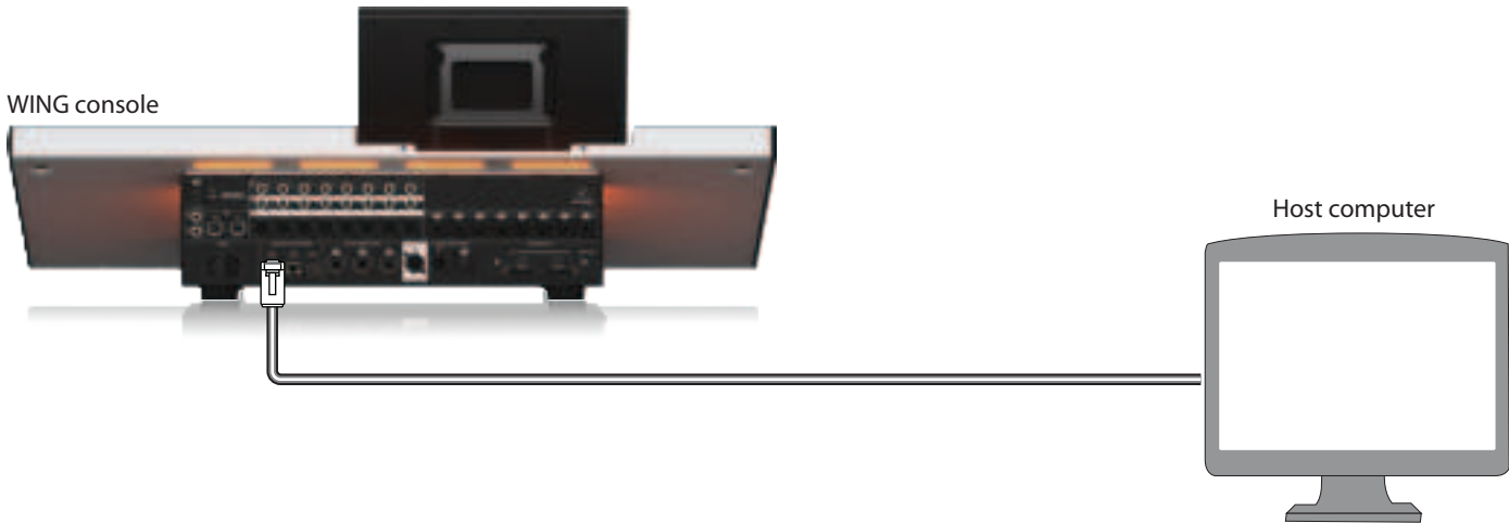
Fig. 1: Conexão direta entre WING e computador host
