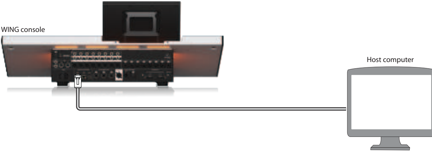
Fig. 1: Conexión directa entre WING y la computadora anfitriona
