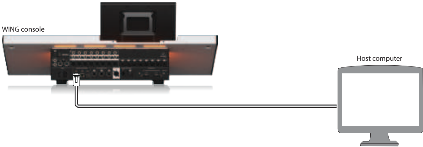
Fig. 1 : Connexion directe entre WING et l'ordinateur hôte
