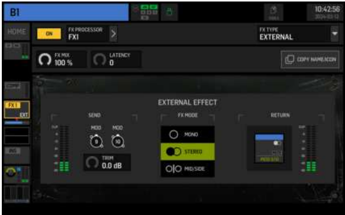
Abb. 7: External als Insert-Punkt auf einem Bus geladen
