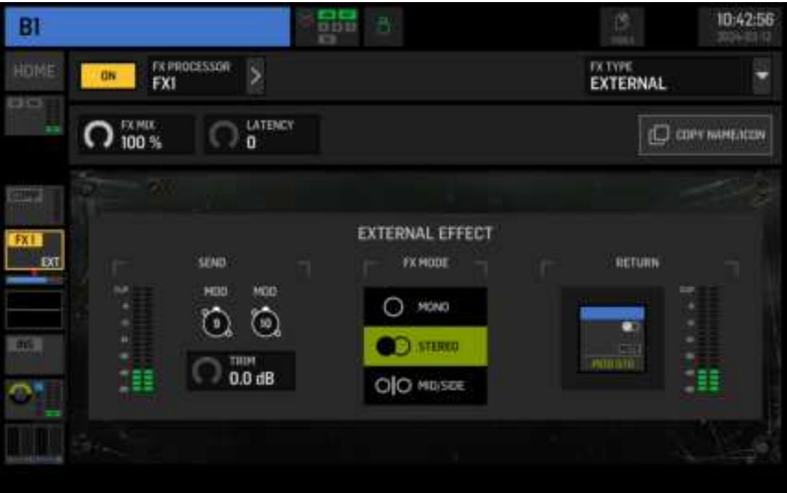
Fig. 7 : External chargé comme point d’insertion sur un bus
