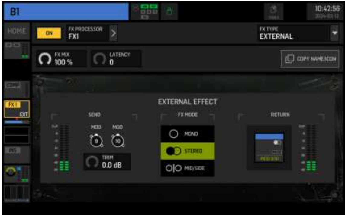
Fig. 7: External laddad som infogingspunkt på en buss
