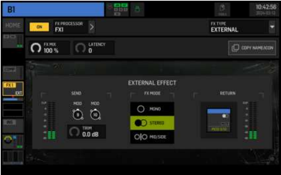
Fig. 7: External załadowany jako punkt wstawienia na magistrali
